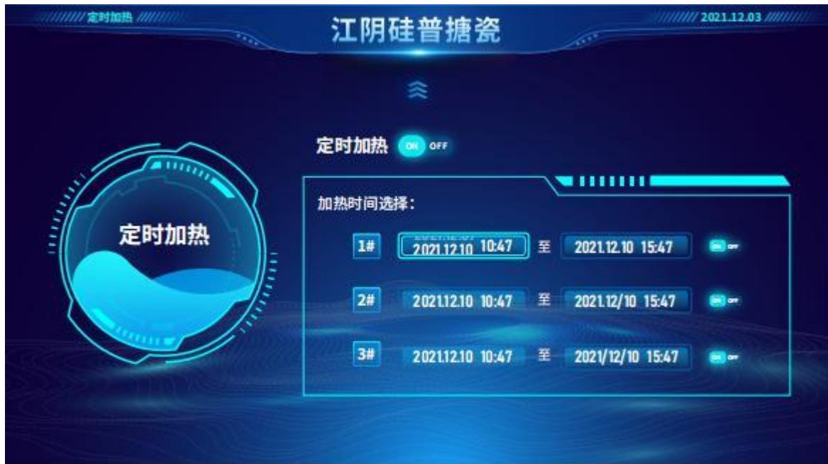
把 按钮打到“ON”状态，则定时加热模式已经打开，打到“OFF”则为自动加热模式。定时加热模式中可以设置三组时间段，“1#”、“2#”、“3#”；三组加热时间段可以单独启动也可以任意组合使用，例如：可以选择“1”也可以“1+2”；“2+3”；“1+2+3”等等。
