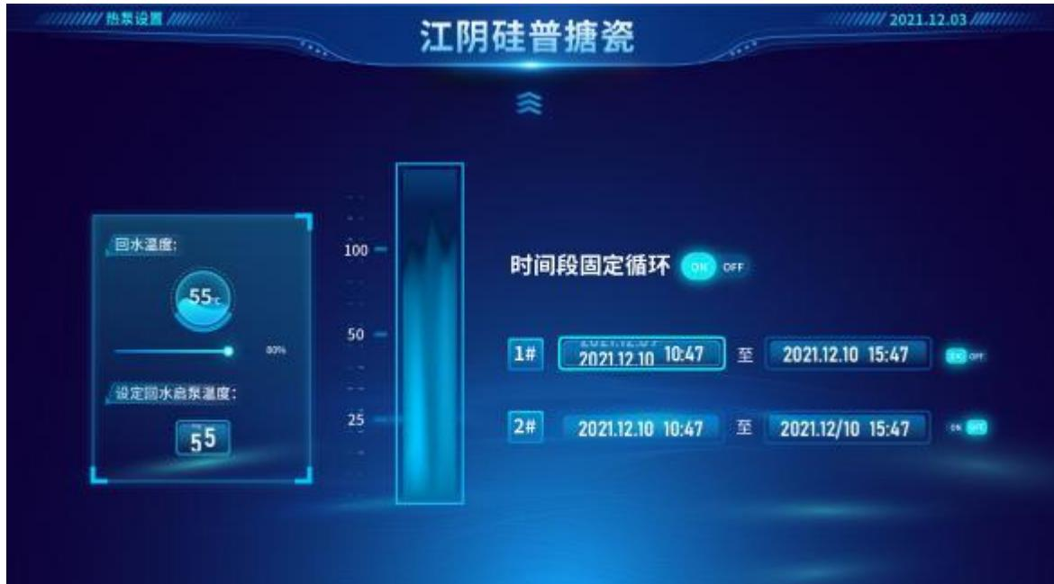
首先设置管道回水温度（回水温度不超过 50°C），将
