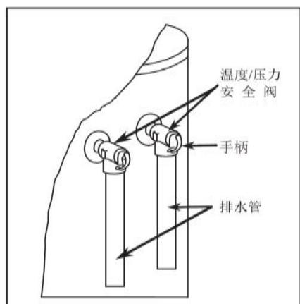
警示：不得有任何原因致使温度/压力安全阀的排水管堵塞！排水管的出水应于大气相通，并保证排出热水不会危及人身安全或造成财产的损坏。
